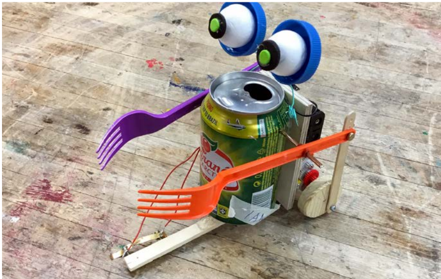
Fährt dieser Roboter an die Tischkante, schaltet der Motor ab.
