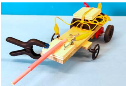
Fährt dieser Roboter an die Tischkante, schaltet der Motor ab.
